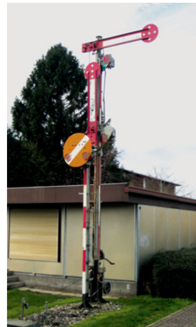
Semaphorsignal (Rot) und Klappscheiben-Vorsignal (Orange) in Güttingen
