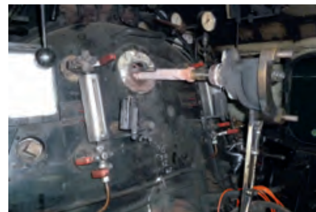
Der Regulatorblock wird unter die Lupe genommen.
