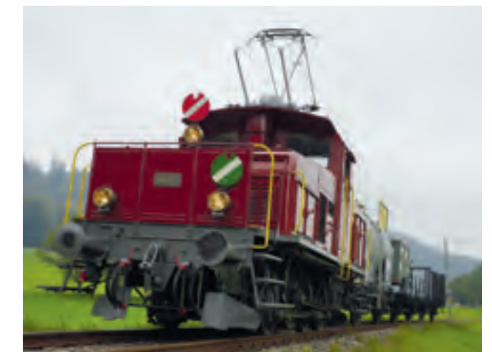
Extragüterzug mit historischer Fracht – Ee3/3 mit gesteckten Sperr- sowie Fahrberechtigungstafeln
