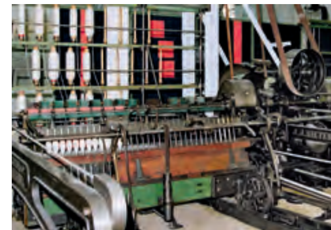
Wagenspinnmaschine Selfaktor Rieter 1889
